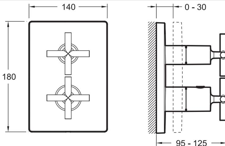
Descriptif CCTP : Mitigeur thermostatique avec robinet d'arrêt - poignées Classic. E75388. Collection : MODULO. TYPE D'INSTALLATION : Encastré. NORMES ET RÉGLEMENTATIONS : ACS : 14 ACCLY 587. TYPE DE SYSTÈME DE ROBINETTERIE DE BAIN : Avec Système Modulo.
